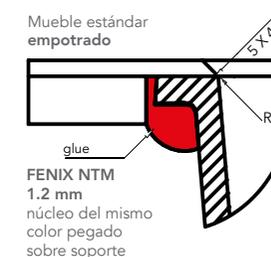
*Se pueden llevar a cabo diversas operaciones de mecanizado y de incisión en las placas FENIX con núcleo del mismo color. Sin embargo, tenga en cuenta que la incisión alterará la estructura superficial de la placa FENIX y dará lugar a la pérdida de todas las características específicas del producto.*
