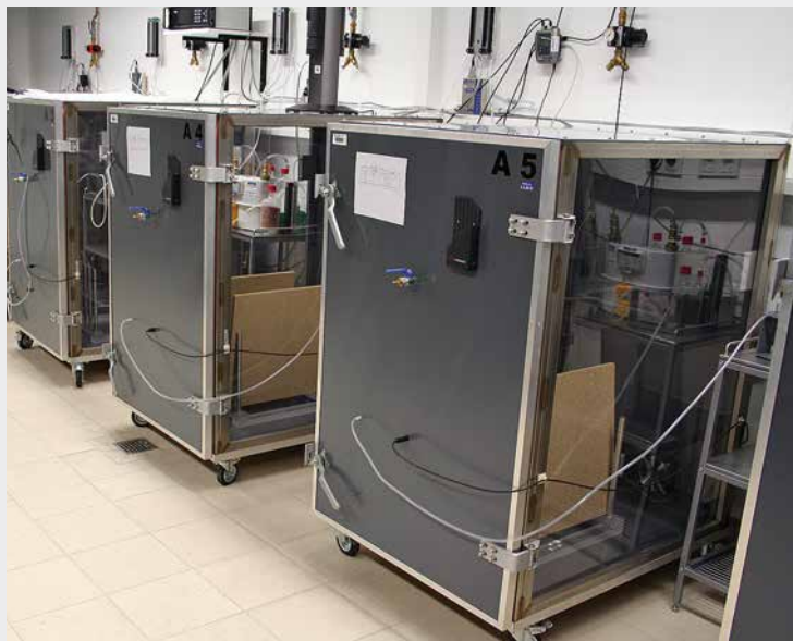
Cámaras de ensayo de 1 m³ del Instituto Fraunhofer (WKL).
