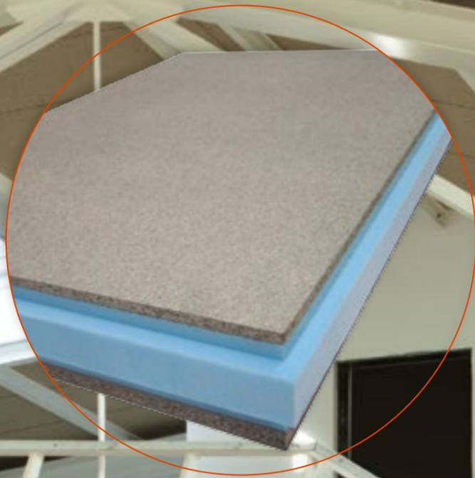
**THERMOCHIP THH** es el acabado más sencillo de la gama. Está formado por dos tableros de aglomerado hidrófugo, unidos a un núcleo de poliestireno extruido. Permite diversas configuraciones en función de su uso y de las prestaciones requeridas -atendiendo fundamentalmente
